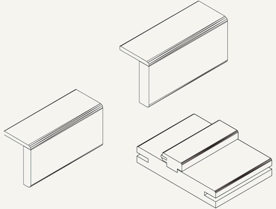
Marco Interno y Marco Externo: Compuesto de madera y plástico + laminación de PVC duradera.
